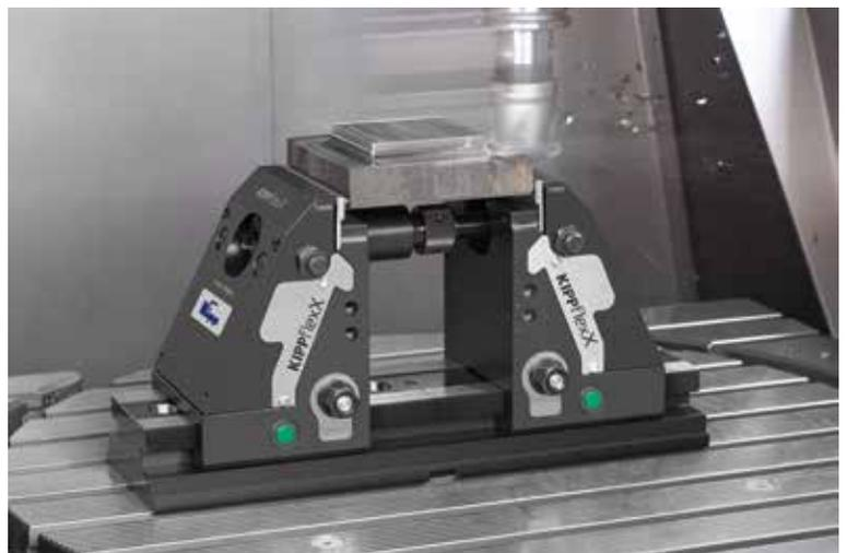
5-Seitenbearbeitung auf einer 5-Achs Fräsmaschine.
