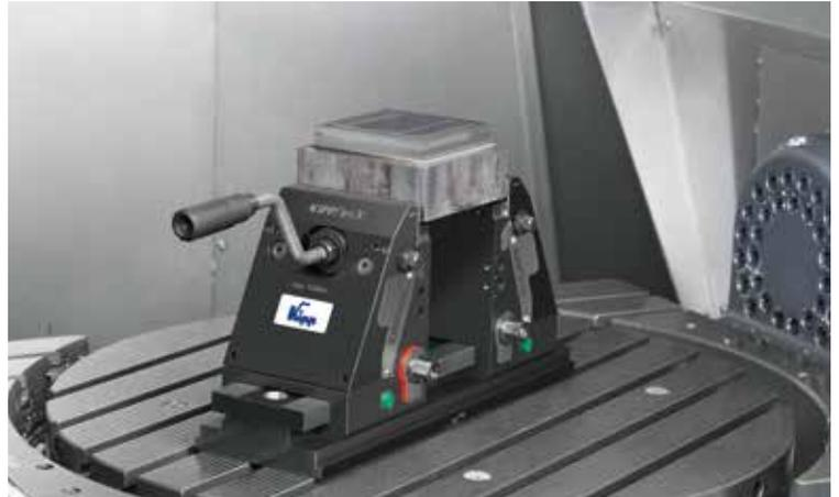
Niederzugspannung mit dem KIPPflexX in Zentrisch-Spanner Funktion. Beide Klemmbacken sind geschlossen, sodass bei Kräfteinleitung - durch Überbiegung der anliegenden Spannbacken - ein Niederzug auf die Werkstückauflage erzeugt wird.
